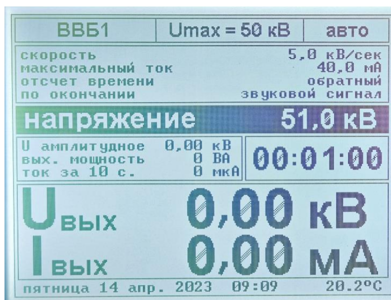
Рисунок 14 – Экран стенда при работе с внешним высоковольтным блоком при автоматическом управлении выходным напряжением
