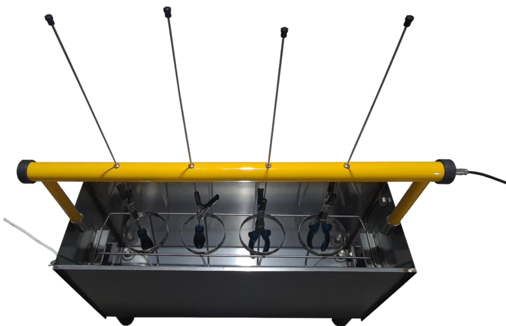
Рисунок 17 – Установка инструмента в ванну для испытания
