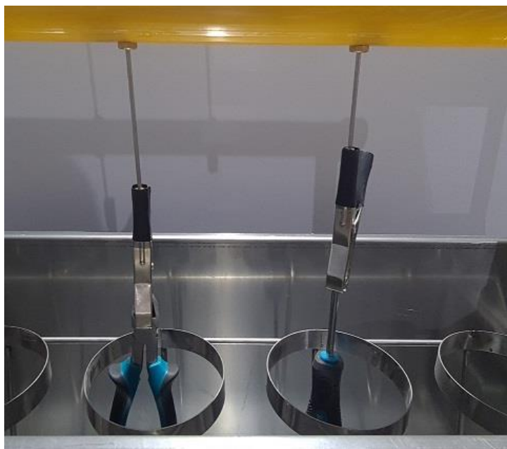
Рисунок 18 – Подключение электроинструмента при помощи зажимов типа «крокодил»
