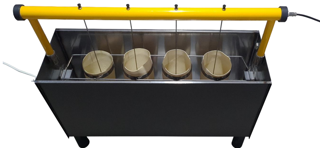
Рисунок 15 – Установка перчаток в ванну для испытания
