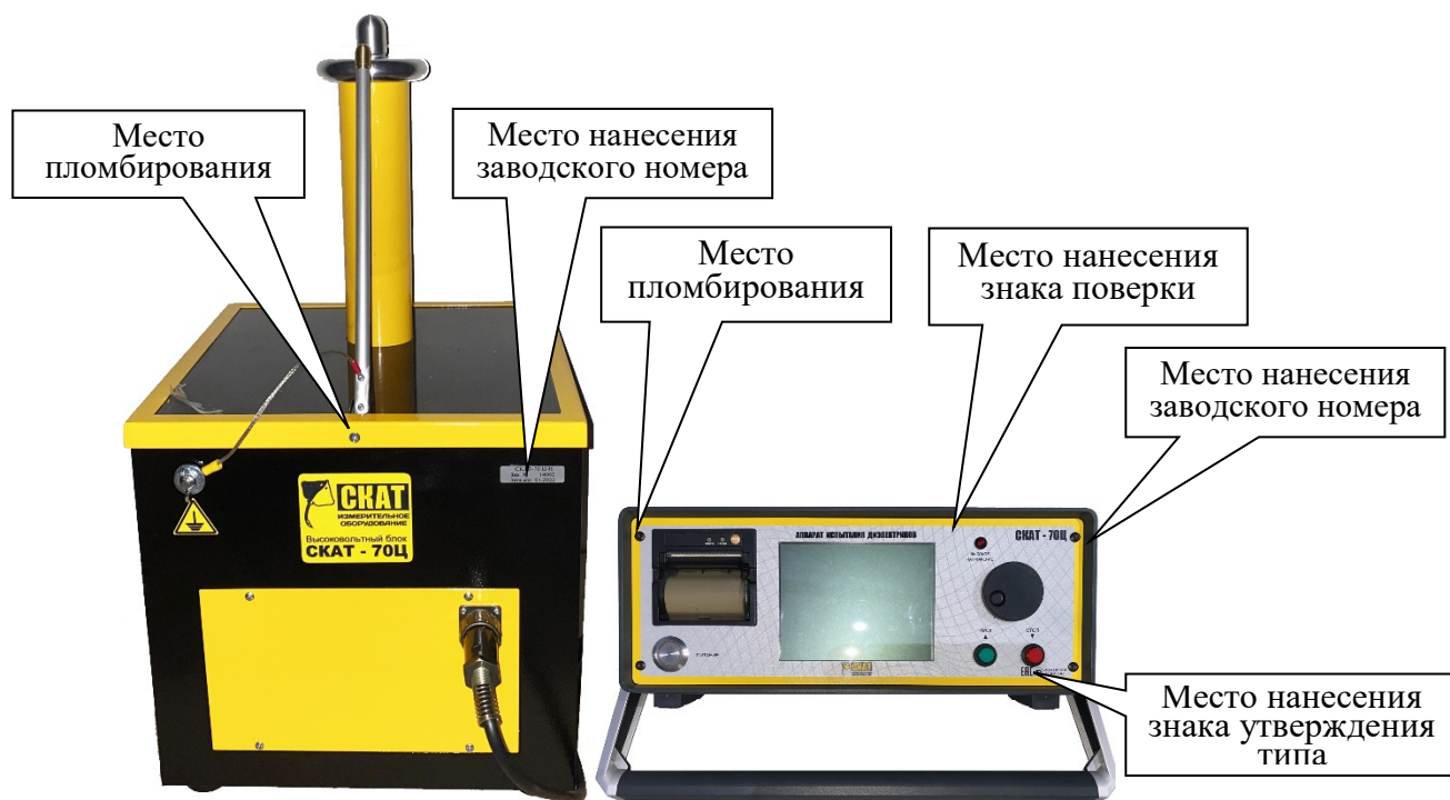
Рисунок 3 – Общий вид аппаратов СКАТ-70Ц-Н, СКАТ-70ЦА-Н с указанием мест пломбировки от несанкционированного доступа, мест нанесения заводского номера, знака поверки и знака утверждения типа
