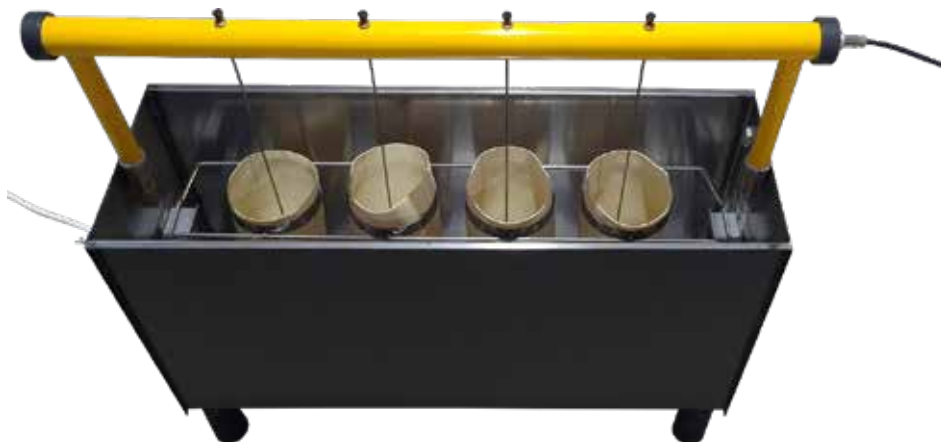
Рисунок 15 – Установка перчаток в ванну для испытания
