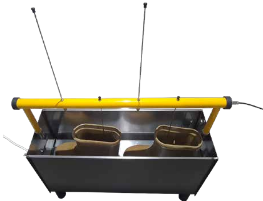
Рисунок 16 – Установка бот в ванну для испытания
