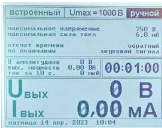
Рисунок 11 – Экран стенда при работе со встроенным источником при ручном управлении выходным напряжением
