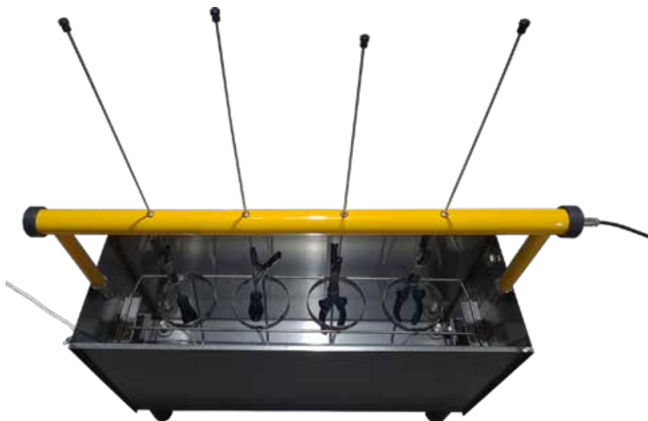
Рисунок 17 – Установка инструмента в ванну для испытания
