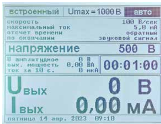
Рисунок 12 – Экран стенда при работе со встроенным источником при автоматическом управлении выходным напряжением
